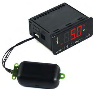
Wi-Fi Модуль позволяет подключить оборудование к системе удаленного мониторинга на базе облачной платформы, дает возможность удаленно контролировать и управлять оборудованием с ПК, планшета или смартфона, получать сигналы аварийной тревоги, 24 часа в сутки без дополнительной абонентской оплаты.
