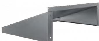
Козырек защитный размещается над наружным блоком холодильной машины на расстоянии около 300 мм, установленной на улице, и служит для защиты его от атмосферных осадков, механических повреждений посторонними предметами и прямых солнечных лучей.
