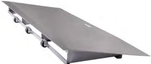
Пандус предназначен для закатывания транспортных тележек в холодильные камеры с контейнерными и откатными дверьми, световой проем которых 1200\*1850 мм. Конструкция пандуса позволяет легко перемещать его к дверному проему камеры за счет установленных с обратной стороны настила полиамидных роликов.
